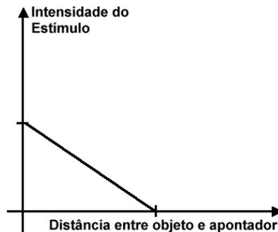
**Figura 8 – Controle da intensidade de um atuador baseado na distância até um objeto**
